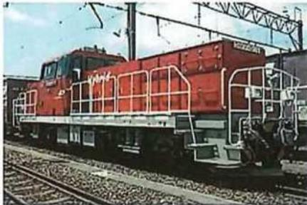
貨物駅構内での貨車入換作業における環境負荷低減のため、小型ディーゼルエンジンと大容量リチウムイオン蓄電池を組み合わせたシリーズ式ハイブリッド機関車HD300形式を開発し導入しています。環境性能を既存の入換用機関車と比較すると、燃料消費量36.0%低減<sup>※1</sup>、窒素酸化物(NOx)排出量61.4%低減<sup>※1</sup>、騒音レベル22dB低減<sup>※2</sup>を各々実現しています。2010年に試作車、2012年に量産1号機、2014年に寒冷地仕様車(500番代)を導入し、2022年4月1日現在、全国の支社管内の各駅で41両運用し、貨物駅における入換機関車として環境負荷の低減を実現しています。
