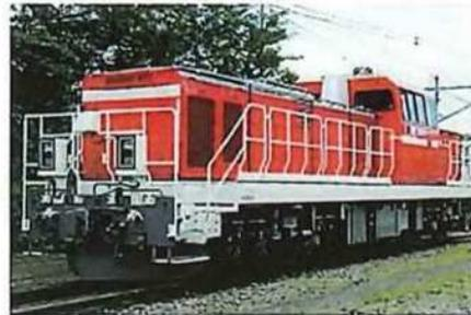
橋梁強度が低い線区にも入線可能な本線・入換兼用ディーゼル機関車の置換を目的に、DD200形式電気式ディーゼル機関車を開発し、導入しています。環境負荷低減に配慮し、エンジン排出ガスレベルは第2次規制相当で、インバータ装置には電力変換効率が高いハイブリッドSiC(シリコンカーバイド)素子を適用しました。置換前の機関車と比較して、燃料消費量20.3%低減<sup>※1</sup>、窒素酸化物(NOx)排出量18.6%低減<sup>※1</sup>、騒音レベル11dB低減<sup>※2</sup>を実現しています。
